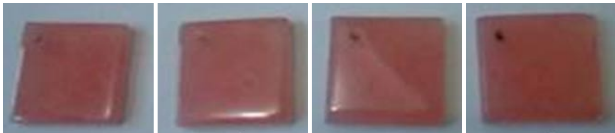
Gambar 1. Resin akrilik sesudah direndam selama 24 hari dalam: a. akuades; b. larutan coklat 6 g : 200 ml; c. larutan coklat 9 g : 200 ml; d. larutan coklat 12 g : 200 ml.
